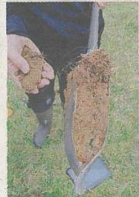
Des sondages effectués à l'aide d'une tarière.
