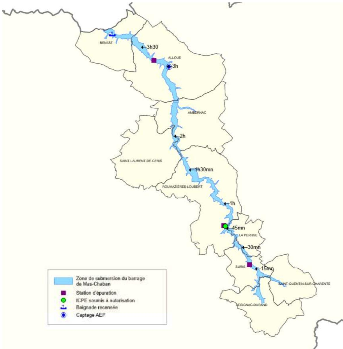
Figure 173 : Zone de submersion du barrage de Mas-Chaban sur la Charente en Charente-Limousine. Source : IGN-BD parcellaire/DDE16/DDAF16/DDASS16/DSV16
