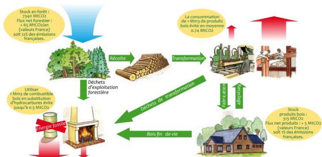
Figure 145 : Schéma explicatif du stockage et des émissions de dioxyde de carbone au sein de la filière bois. Source : FCBA, Le carbone - Carbone Forêt-Bois : Des faits et des chiffres
