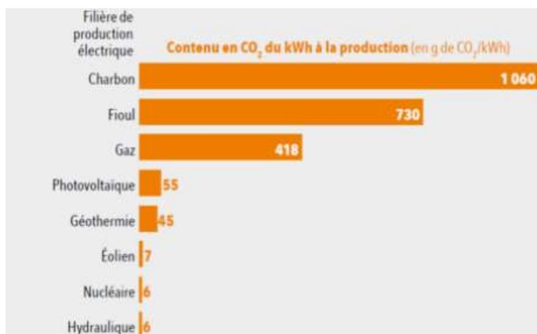
Figure 53 : Contenu en CO<sub>2</sub> du kWh à la production selon les filières - Source : Base carbone ADEME.
