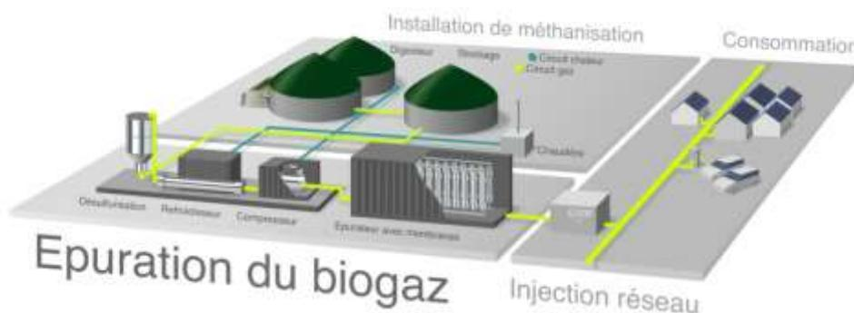
Figure 106 : Illustration du fonctionnement d'une installation de méthanisation qui réinjecte du biogaz dans le réseau de gaz naturel. Source : <https://agrikomp.com/fr/>
